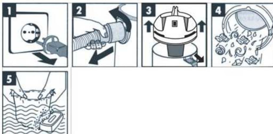
Débranchez votre appareil (schéma 1) et enlevez le tuyau flexible (schéma 2).
