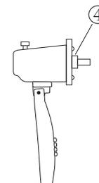
2. Placer la grille arrière (5) sur la tige centrale du moteur (6) et la fixer à l'aide de l'écrou (4) en vissant dans le sens des aiguilles d'une montre.
