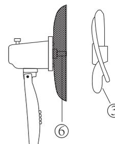
4. Visser l'écrou pour hélice (2) sur la tige (6) en la tournant dans le sens inverse des aiguilles d'une montre.
