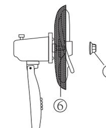
5. Placer la grille avant (1) sur la grille arrière (5) puis les assembler à l'aide des verrous ajustables. Visser les deux parties ensemble à l'endroit prévu sur la partie supérieure.
