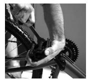
Fixez les pédales avec précaution, la pédale marquée R doit être fixée à droite et tournez dans le sens des aiguilles d une montre. La pédale marquée L, doit être fixée à gauche et tournez dans le sens contraire des aiguilles d une montre. Serrez les pédales fermement à l'aide d une clé de 15mm et retournez le vélo a l'endroit.
