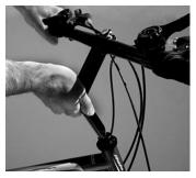
Retirez le capuchon protecteur du guidon et dévissez le boulon central à l'aide d une clé de 13 mm ou clé Allen 6 mm. Insérez la tige du guidon dans la tête du guidon en vous assurant que le guidon et la fourche sont dirigés vers l'avant. Afin d'ajuster le guidon correctement dévissez l'écrou à l'aide d une clé de 13 mm.
