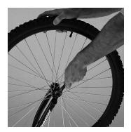
Retournez le vélo et faites le reposer sur la selle. Insérez la roue de devant dans la fourche. Serrez à l'aide d'une clé de 1 4 / 1 5 mm. Assurez-vous que la rondelle est bien présente entre la vis de la roue et la fourche.
