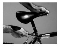
Insérez la partie la plus fine du tube dans la selle serrez, insérez ensuite le tube de la selle dans le trou prévu à cet effet et serrez.
